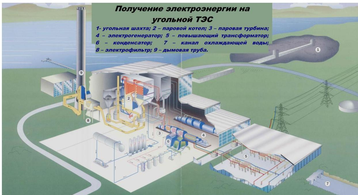
Рисунок 1 – Преобразование энергии на ТЭС
