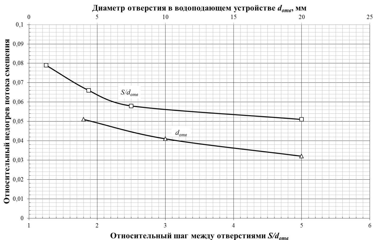
Рисунок 7 Влияние на теплообмен диаметра отверстий и относительного шага между ними для водоподающего устройства СПВД
