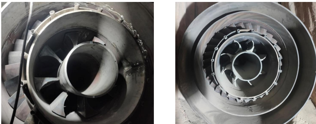
Рисунок 8 – Разное исполнение рассекателей на пилотном образце поворотной горелки (слева – исходный вариант с объёмными рассекателями, справа – новый вариант с рассекателями из половины трубы)
