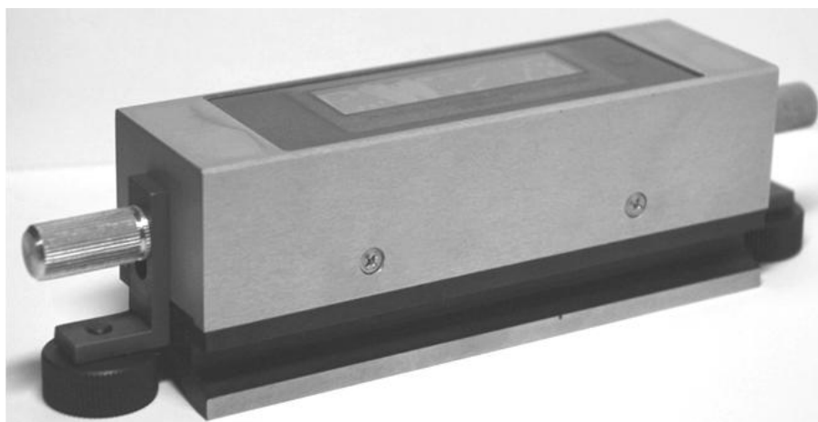
Рис. 9. Электронный брусковый уровень УБЭ5-150
