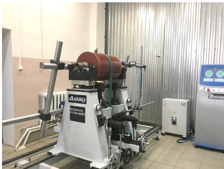
Рис. 3. Балансировка приводного электродвигателя
