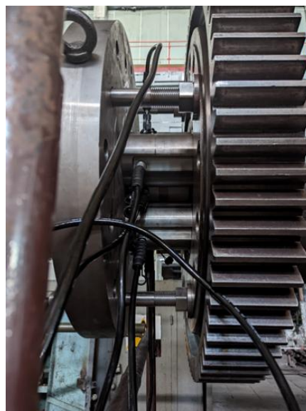
Рис. 4. Приложение осевого усилия к полумуфте ротора:
