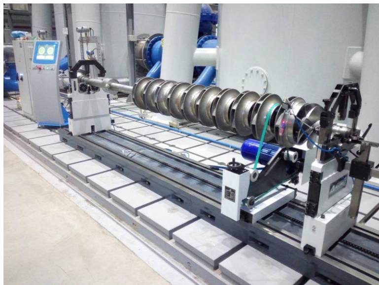
Рис. 4. Балансировка насоса с 10-ю колесами
