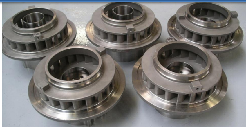
Горелочные устройства для комплекта ГТУ
