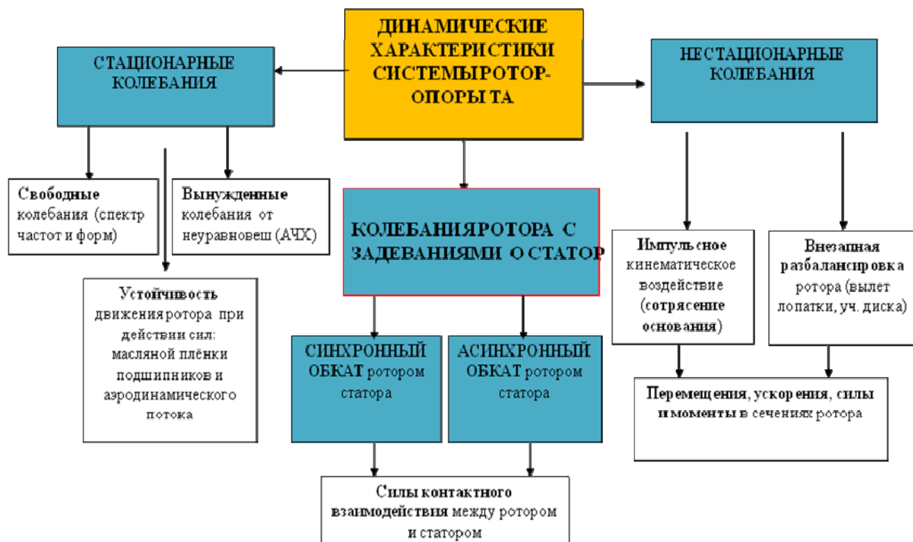
Рис. 37. Структура комплекса программных средств исследования динамики ротора.
