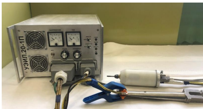
Рисунок 3. Генератор электроискровых импульсов в сборе с вращающимся аппликатором
