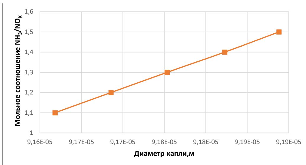
Рисунок 4. Зависимость диаметра капли от мольного соотношения \text{NH}_3/\text{NO}_x для форсунки d_0 = 3 мм
