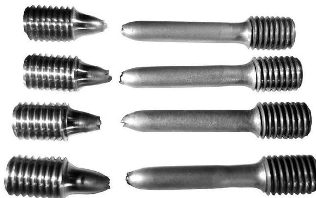
Рисунок 1. Образцы из контрольных сварных соединений после испытаний на растяжение
