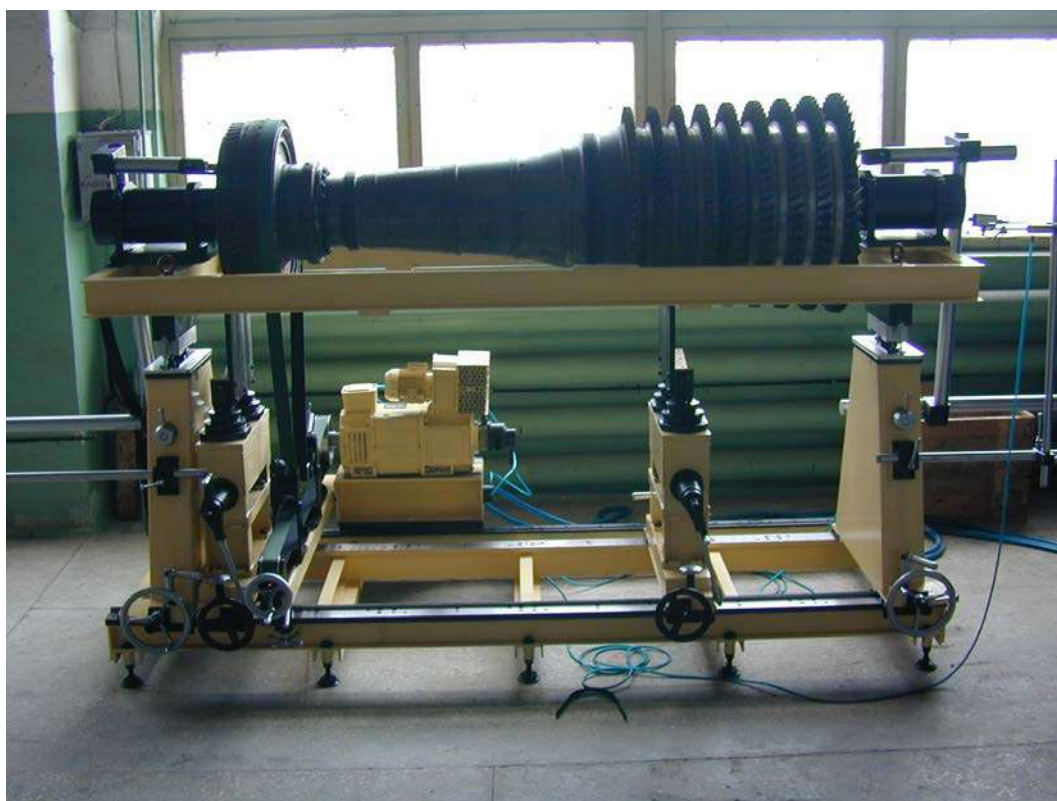
Рис. 7. Балансировка газовой турбины с использованием приспособления типа «рамка»
