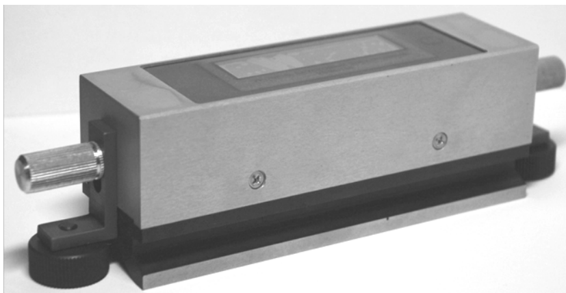
Рис. 11. Электронный брусковый уровень УБЭ5-150
