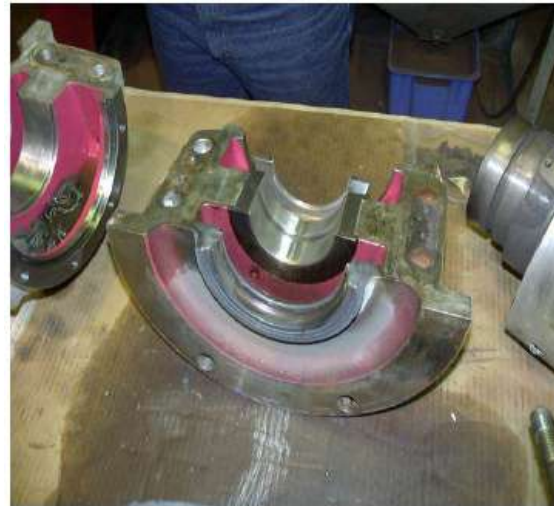
Рис. 8. Четырехклиновой подшипник насоса НРТ 300–400/6s (Sulzer)
