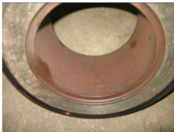
Рис. 2. Гидравлическая нарезка на поверхности цилиндрической щели статорной детали разгрузочного устройства
