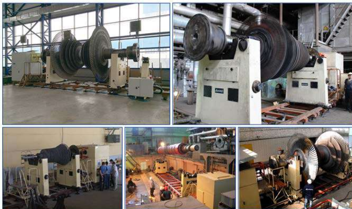
Рис. 1. Балансировочные станки ООО «ДИАМЕХ 2000» для роторов энергетических турбоагрегатов
