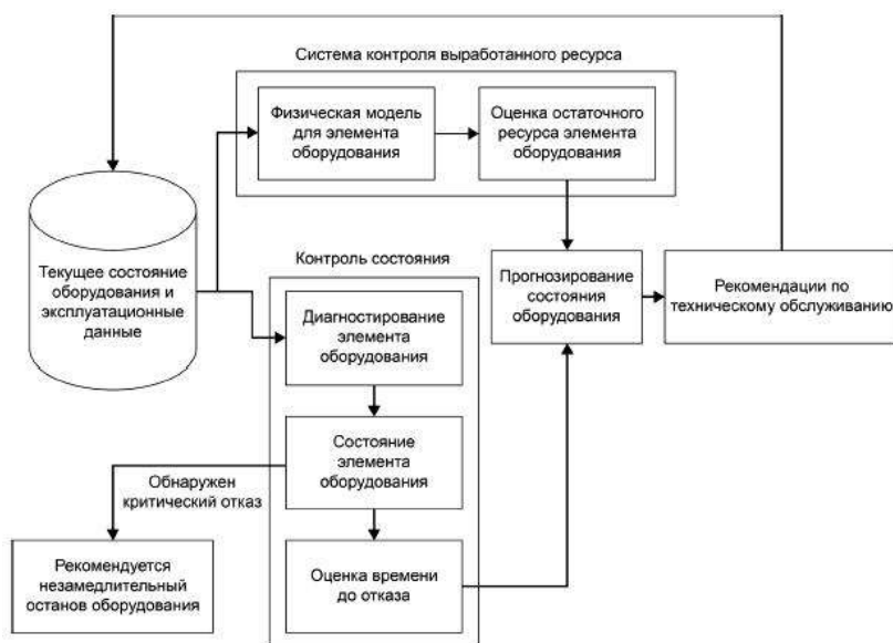
Рис. 6. Блок-схема диагностирования и прогнозирования развития отказов
