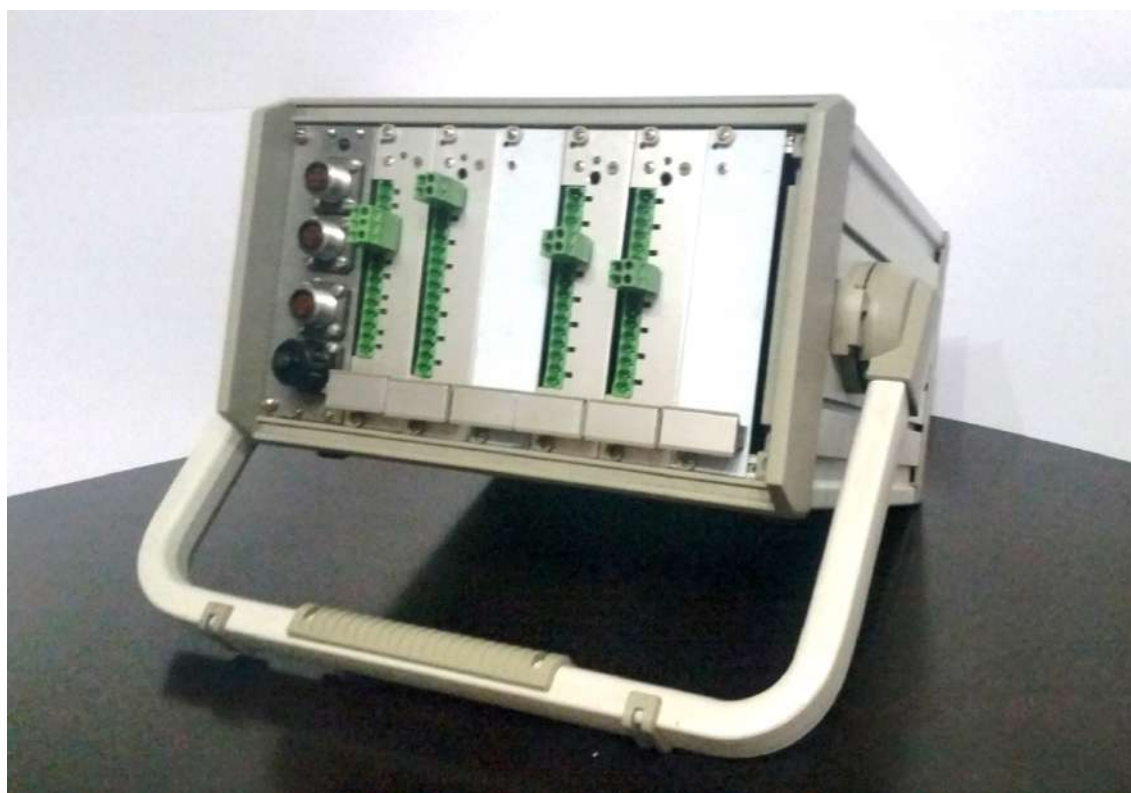
Рис. 5. Внешний вид крейта МСДИ с установленными измерительными модулями
