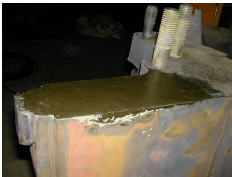
Рис. 5. Внешний вид горизонтальной уплотнительной поверхности обоймы диафрагмы 26-й ступени после формирования состава «Belzona 1591»
