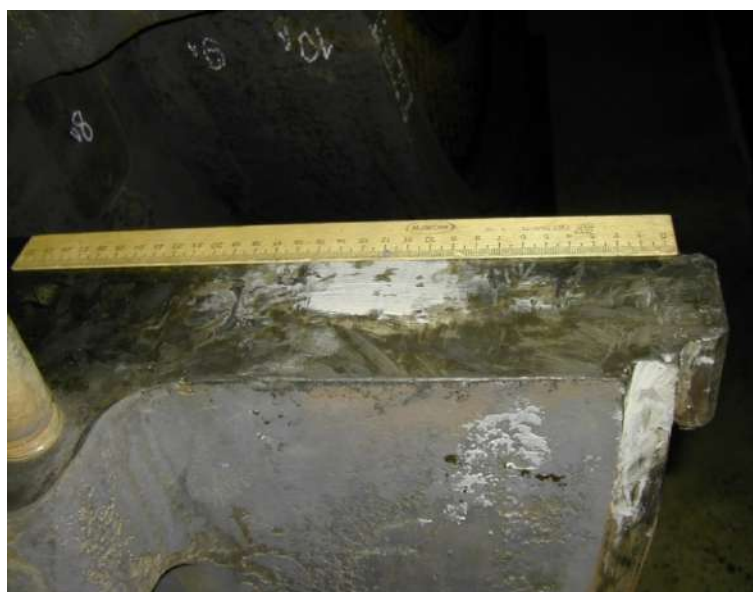
Рис. 4. Плоская горизонтальная уплотняющая поверхность обоймы диафрагмы 26-й ступени с нанесенным композитом «Belzona 1111» на электроискровой подслое
