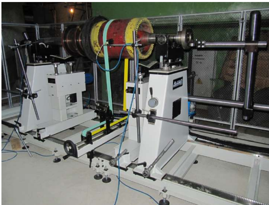
Рис. 3. Станок типа VM3000 для оборудования весом до 3000 кг
