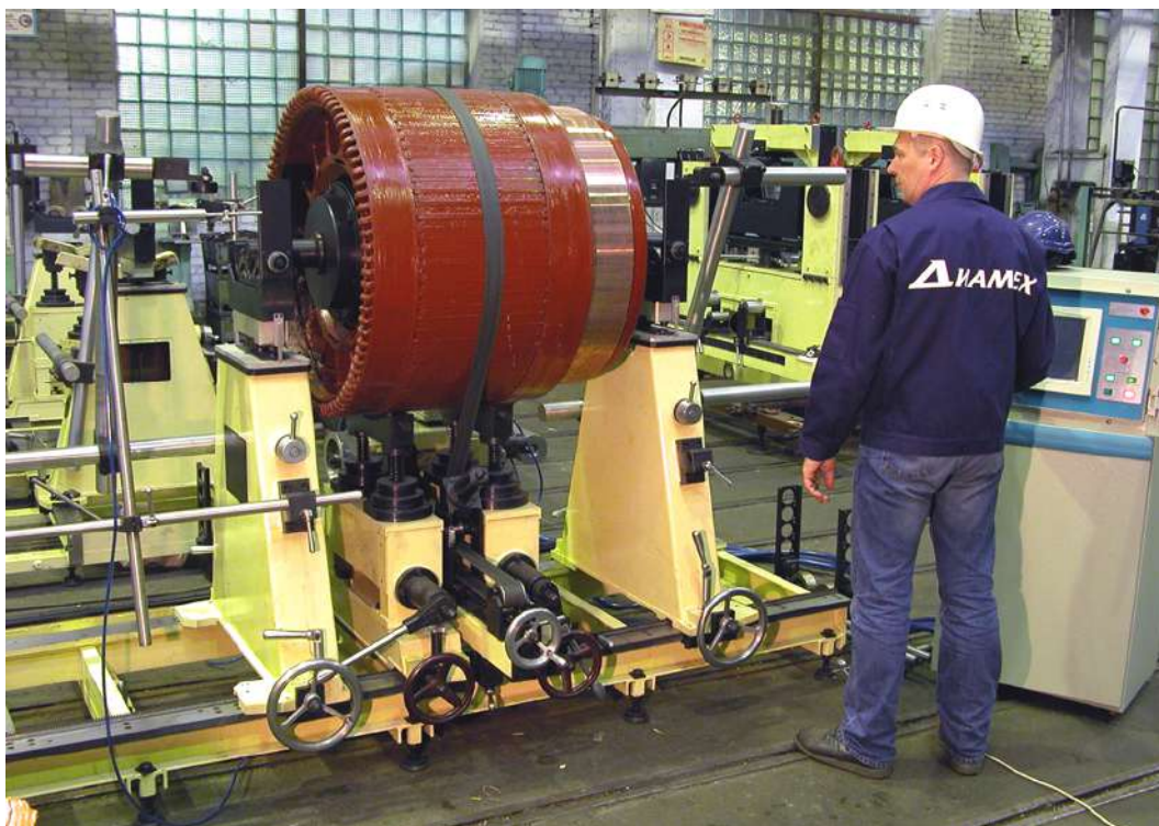
Рис. 6. Балансировка ротора с использованием оснастки
