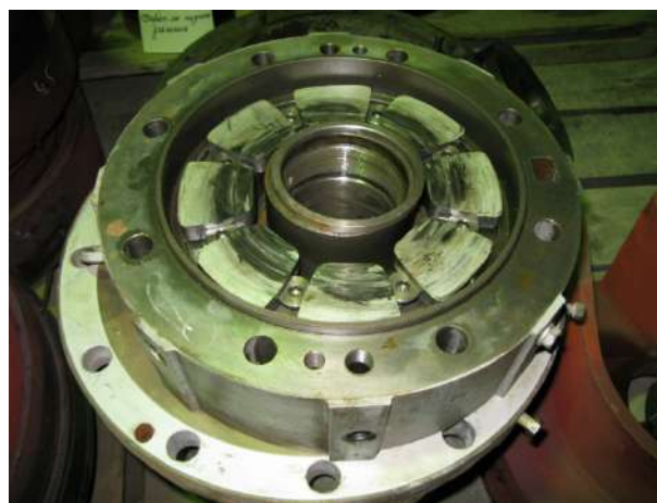
Рис. 5. КСБ (8 сегментов на одной стороне, всего 16 сегментов)
