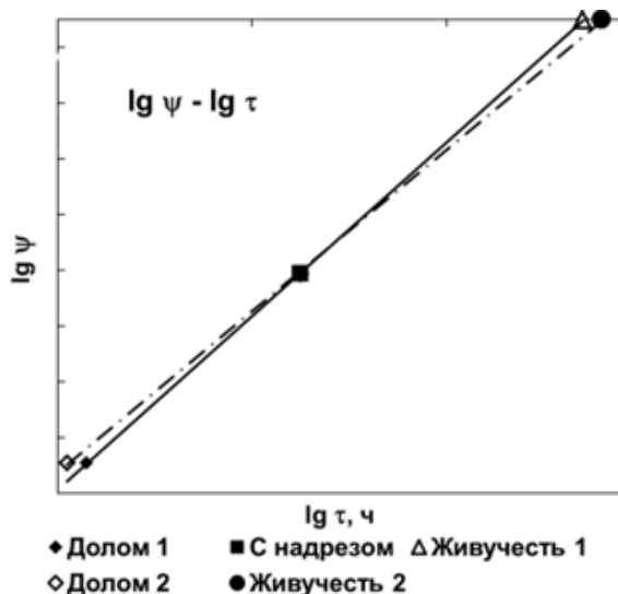
Рис. 1. Влияние начальной сплошности и долговечности образца с особо глубоким и острым надрезом (т. «С надрезом») в условиях ползучести при различном времени долома (т.т. «Долом 1» и «Долом 2») на величину прогнозируемого времени живучести (т.т. «Живучесть 1» и «Живучесть 2») гладкого образца
