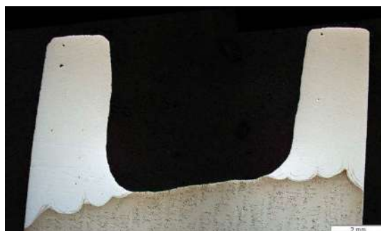
Рис. 5. Поперечный шлиф рабочей лопатки после порошковой наплавки лазером [1]
