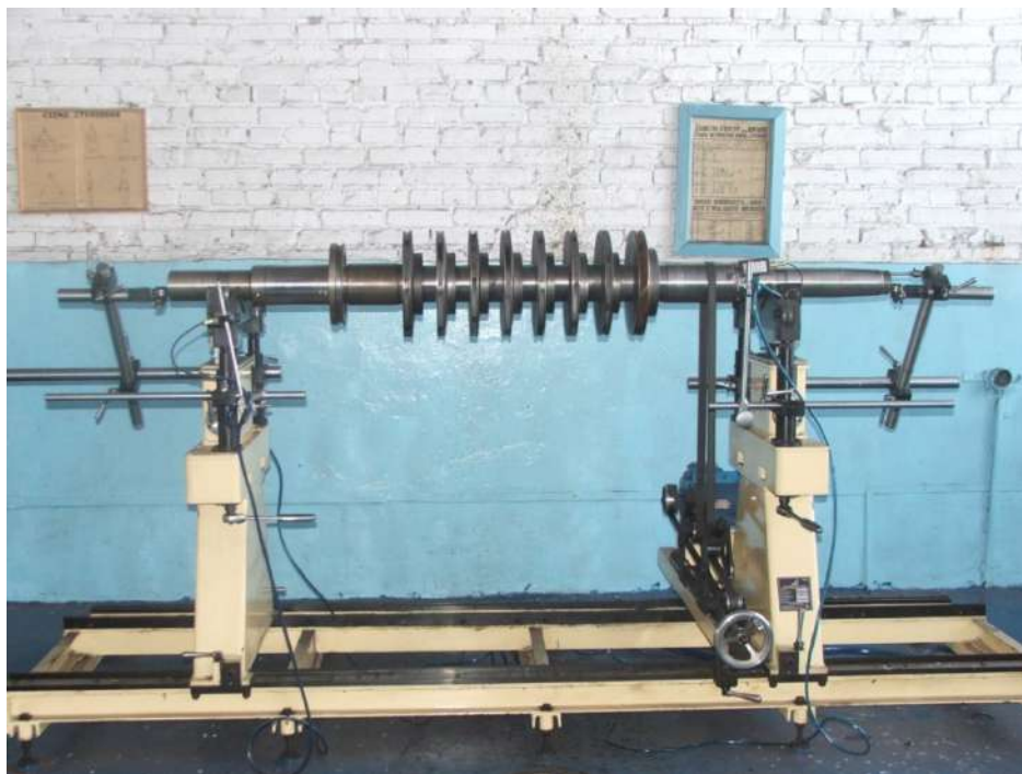
Рис. 4. Станок типа VM1000 для оборудования весом до 1000кг
