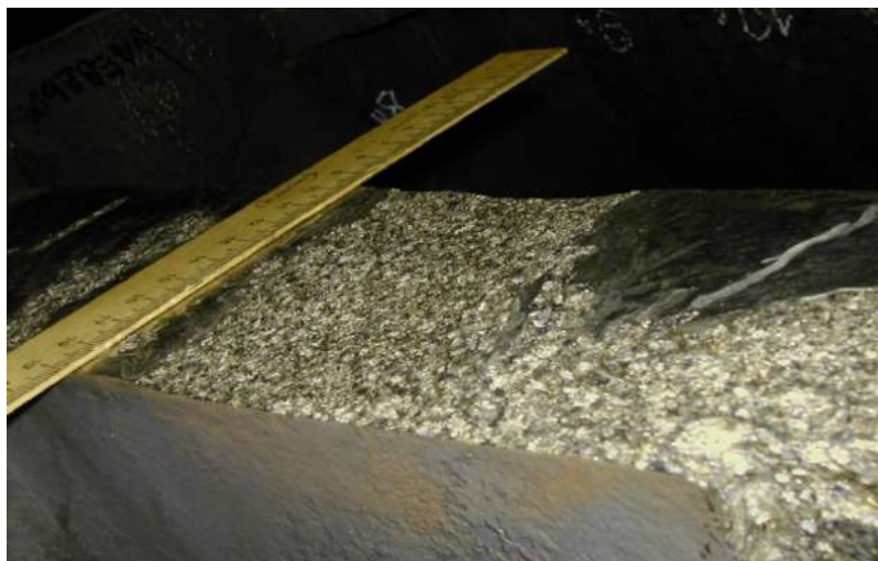
Рис. 3. Внешний вид горизонтальной уплотнительной поверхности нижней половины обоймы диафрагмы 26-й ступени после создания электроискровой подслоя на промытой поверхности
