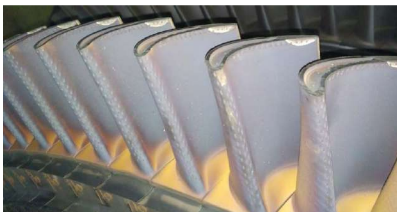
Рис. 5. Следы задевания на торцах пера рабочих лопаток 1-ой ступени турбины
