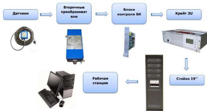
Рис. 2. Измерительная инфраструктура системы виброконтроля «BCB 700» энергетического оборудования ТЭС [5]
