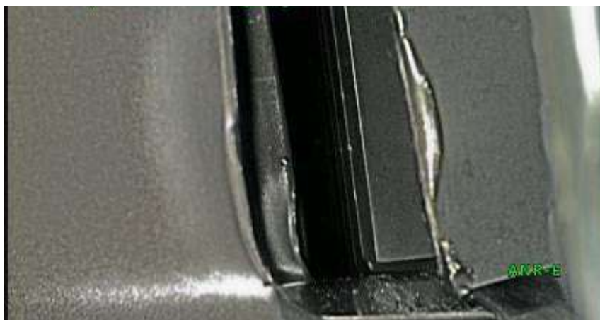
Рис. 3. Следы соударения на роторных и статорных лопатках 3-й ступени компрессора
