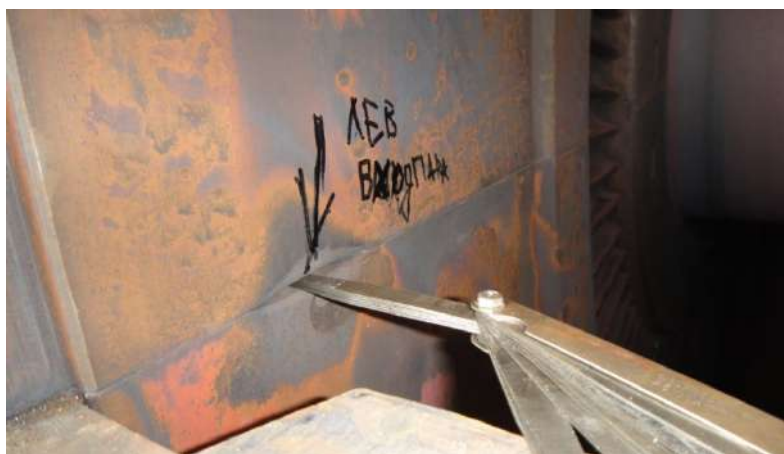
Рис. 1. Фотография промыва верхней и нижней половин горизонтальных уплотнительных поверхностей обойм диафрагм в левой части (суммарная высота размыва составляет около 4 мм на входе пара, ширина — 80 мм)
