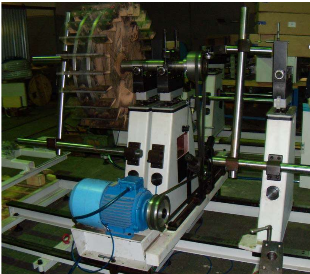
Рис. 5. Балансировка консольного ротора
