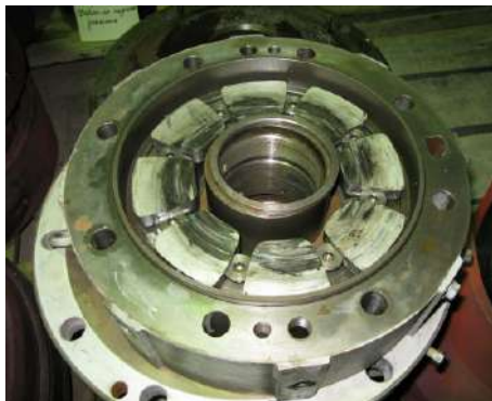
Рис. 8. Установочные колодки упорного подшипника при длительной эксплуатации
