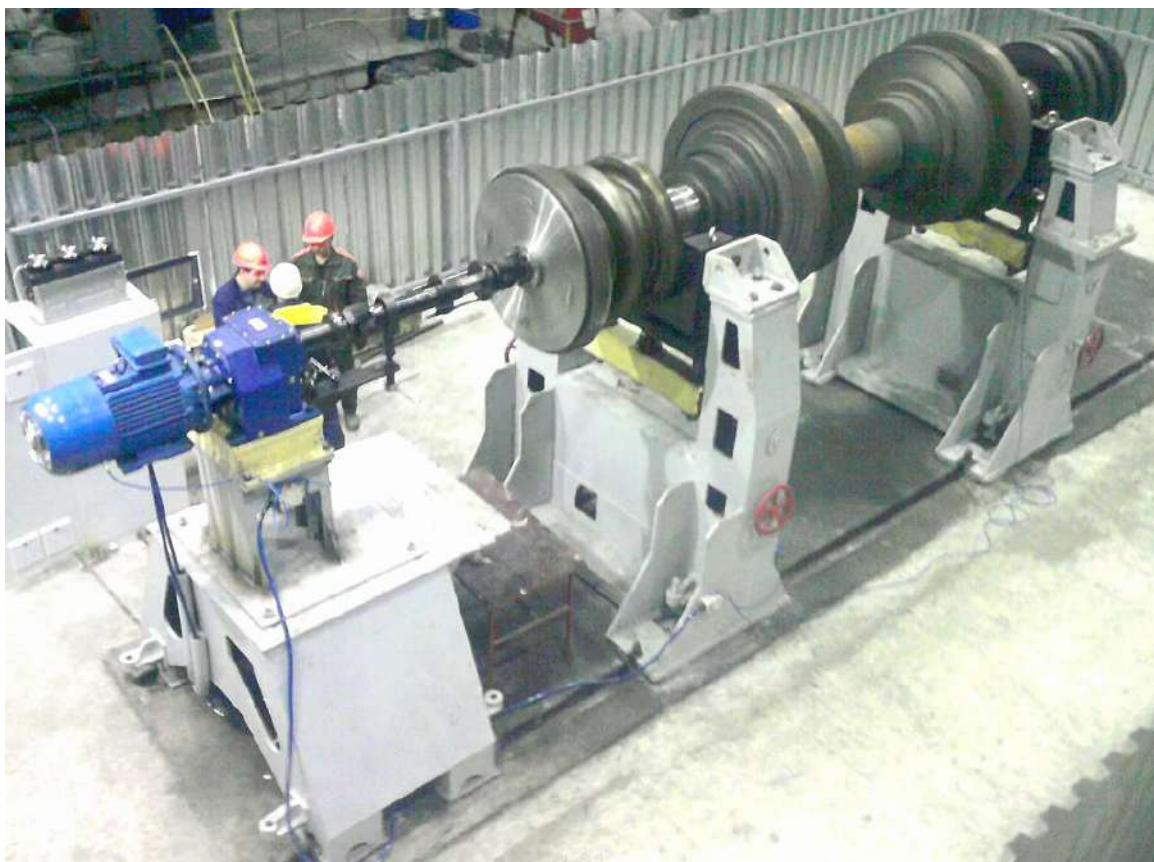
Рис. 2. Модернизированный балансировочный станок для роторов энергетических турбоагрегатов
