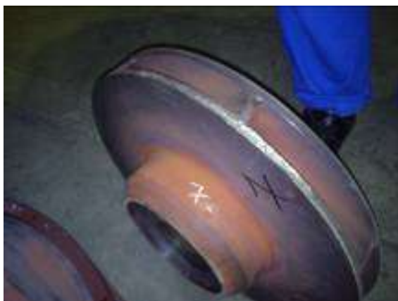
Рис. 1. Следы задеваний на рабочем колесе
