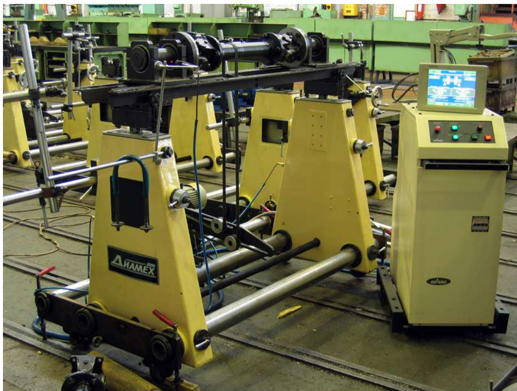
Рис. 8. Балансировка карданного вала на универсальном станке с использованием приспособления типа «рамка»
