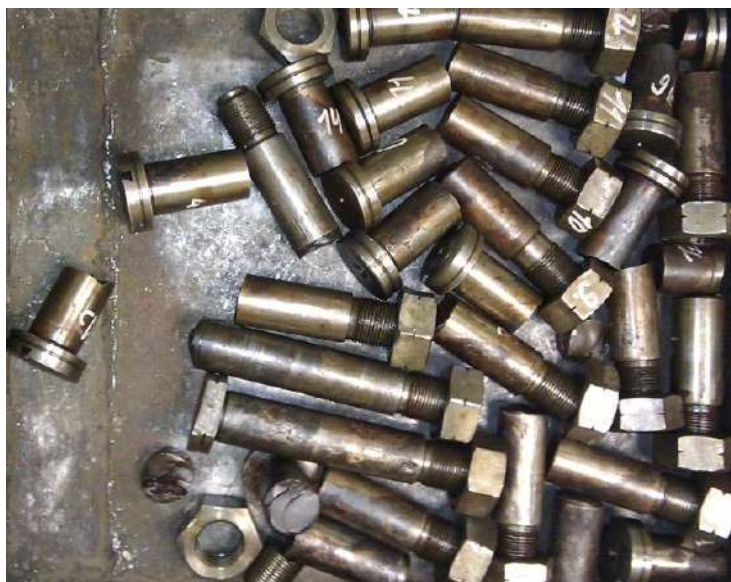
Рис. 5. Крепеж фланцевого соединения роторов при аварии мощного турбоагрегата
