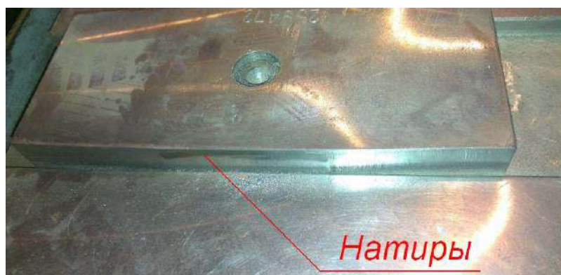
Рис. 3. Состояние элементов СТР турбины 63 МВт после первых пусков: а — паз в подошве корпуса подшипника; б — продольная шпонка
