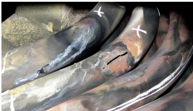
Рисунок 22 – Характер повреждений труб солевого отсека № 31 и № 32
