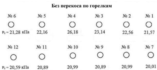
Рисунок 26 – Расположение горелок на фронтальной стене котла
