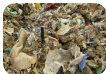
RDF, топливо из отходов измельченное, гранулы или брикеты
