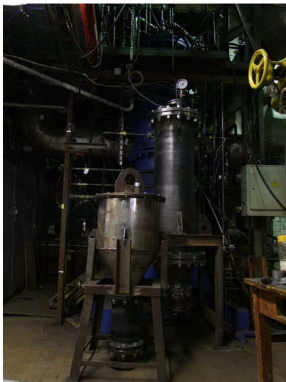
Первоначальный вариант системы топливоподачи
