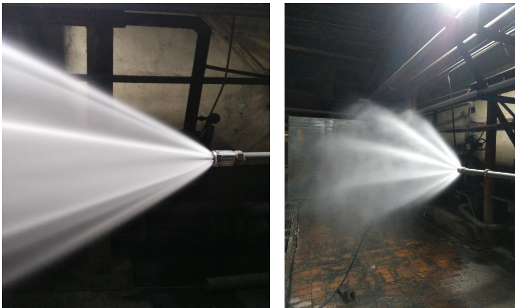
Рис. 4. Испытание мазутной форсунки на распыл
