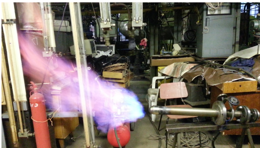
Атмосферные испытания горелки на природном газе
