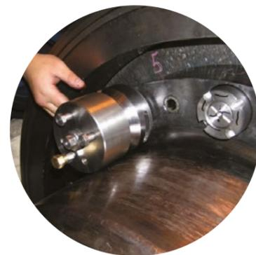
Сборка муфтовых соединений роторов с применением легкоъемного крепежа по технологии ОАО «ВТИ»
