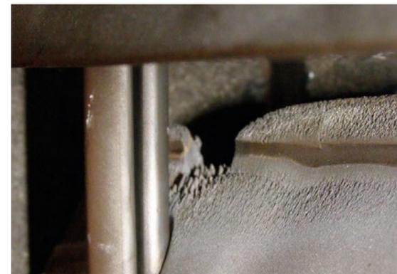
Разрушенная кромка лопатки
