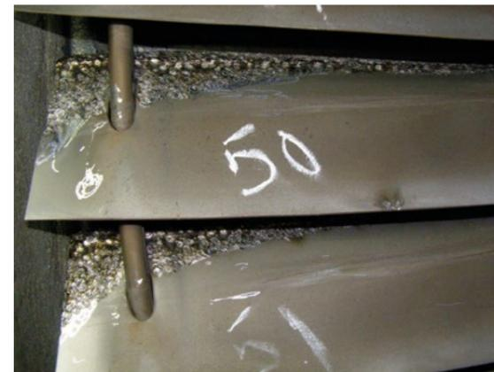
Лопатка с нанесенным покрытием
