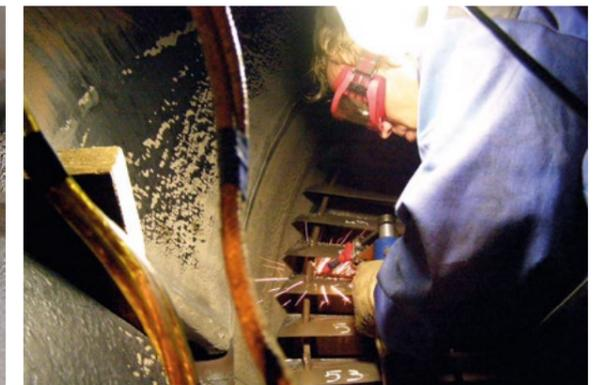
Процесс нанесения упрочняющего покрытия на лопатки турбины
