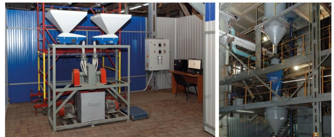
Модель роторно-противоструйной мельницы для получения угольной пыли разной тонины помола
