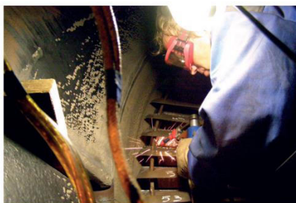
Процесс нанесения упрочняющего покрытия на лопатки турбины
