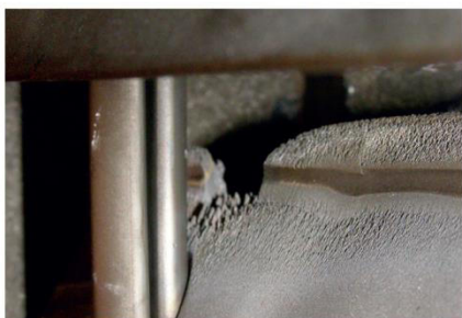
Разрушенная кромка лопатки
