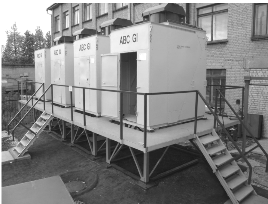
Рис. 1. Экспериментальный стенд макетов воздушного конденсатора
