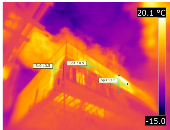
Рисунок 6.7. Термограммы обшивки СВГ (стороны К и L)
