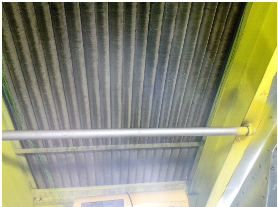
Рисунок 4.7. Вид теплоизолирующей шторы при подаче пара на прогрев (фото автора)
