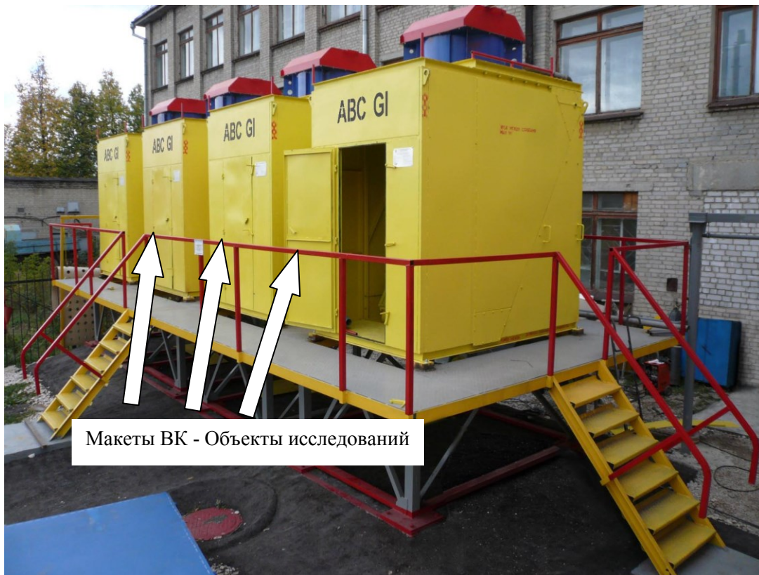
Рисунок 2.1. Фотография макетов воздушных конденсаторов на территории МНИЛ им. В.А. Федорова ЗАО НПВП «Турбокон» (фото автора)
