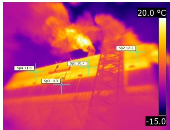
Рисунок 6.7. Термограммы обшивки СВГ (стороны К и L)
