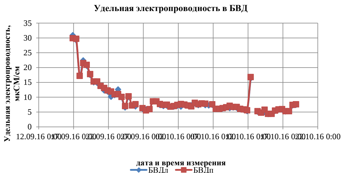
Рис. 10. Электропроводность котловой воды тракта ВД
