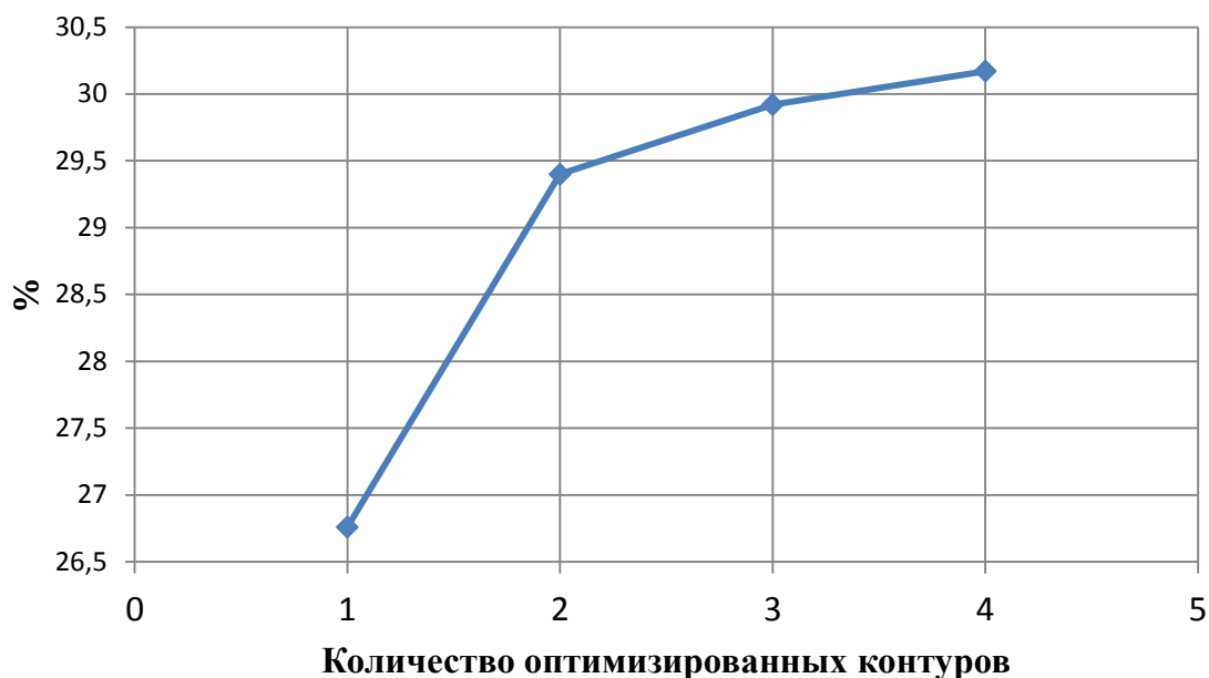
Рис. 3. Влияние количества парогенерирующих контуров котла-утилизатора на КПД ПСУ
