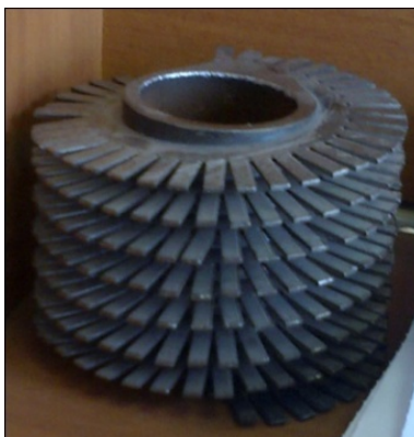
Рис. 2. Фрагмент трубы с просечным спирально-ленточным оребрением
