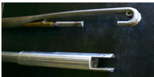
Рис. 2. Внешний вид головок зонда измерения влажности и видеозонда
