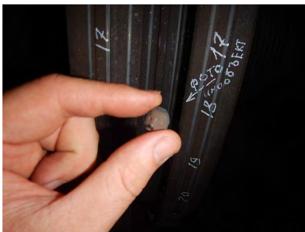
Рис. 5. Элемент округлого грата с окалиной, извлеченный из межлопаточного пространства регулирующей ступени РВД Красноярской ТЭЦ-2.
