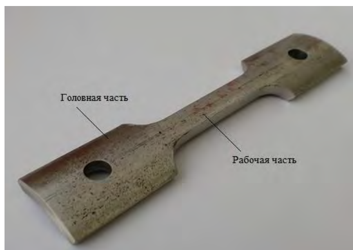
Рис. 3. Образец для испытаний металла труб на ползучесть и длительную прочность
