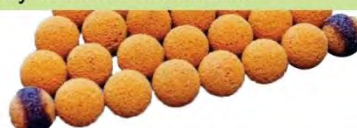
Рис 4. Система шарикоочистки конденсаторов и ее преимущества
