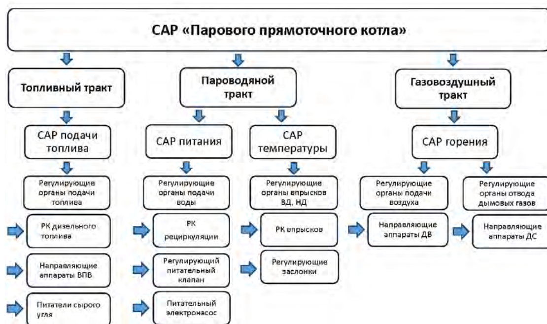
Рис. 2. Структурная схема системы автоматического регулирования
