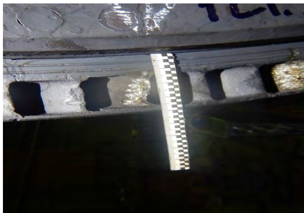
Рис. 4. Состояние входных кромок рабочих лопаток 1-й ступени после нанесения покрытия. Общий вид, забоина отмечена маркером
