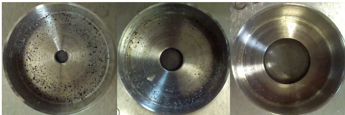
Рис. 4. Фотографии образцов с разными диаметрами искусственных питтингов
