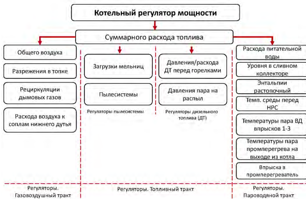
Рис. 3. Структурная схема регуляторов котла
