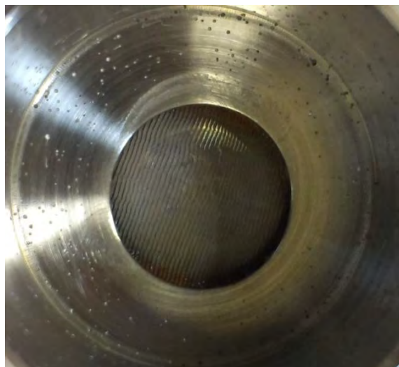
Рис. 6. Образец с не полностью удаленным протекторным слоем (60 ч)
