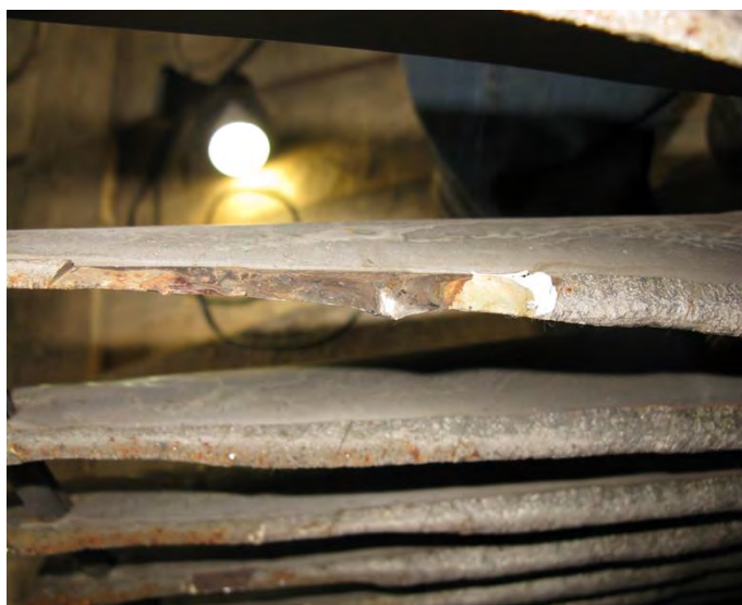
Рис. 1. Входная кромка рабочей лопатки 30-й ступени турбины ПТ-65/75-130/13 ЛМЗ (ст. № 5) в период аварийного останова 23.03.2015 (Филиал «Ярославская ТЭЦ-2»)
