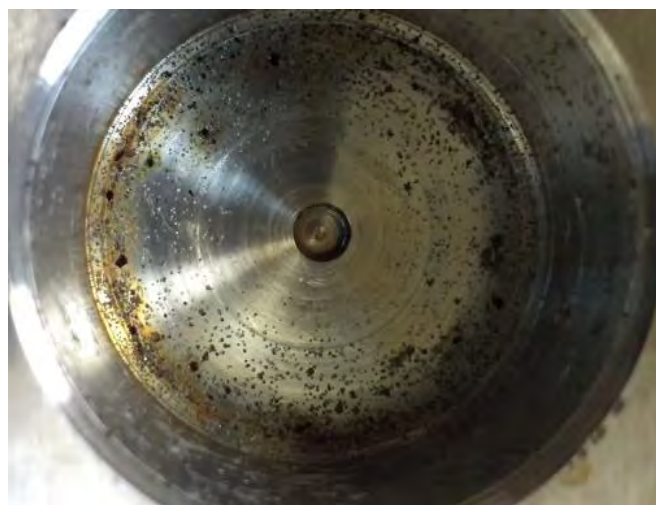
Рис. 5. Состояние поверхности образца (35 ч) со следами ржавчины
