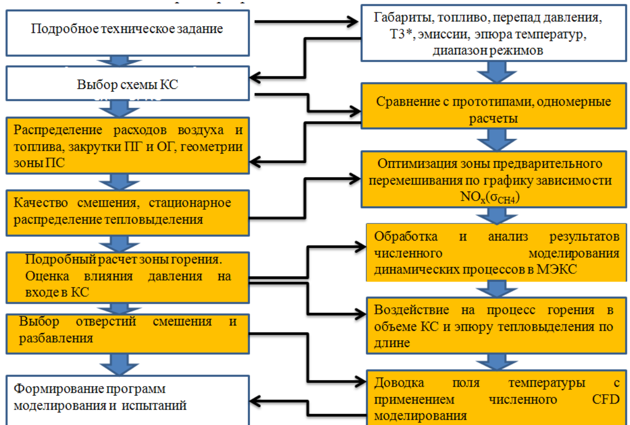
Рисунок 7.1 - алгоритм использования математического моделирования при разработке и доводке КС
