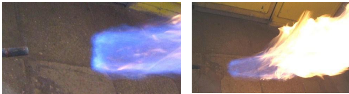
Рисунок 1.18 - горения струи природного газа в воздухе. Эксперимент: 23.07.2007 г. ТЭЦ ОАО «Мосэнерго, зона стабилизации (слева), общий вид факела (справа)
