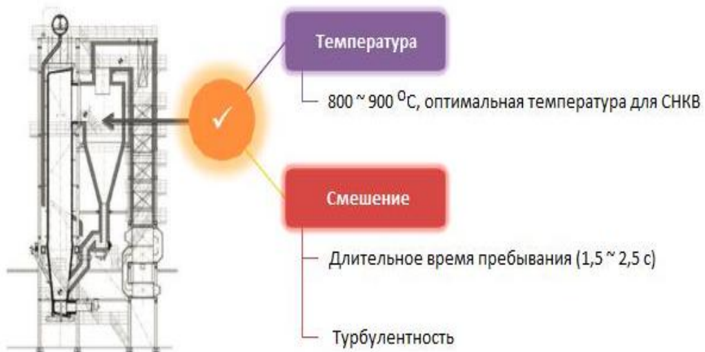
Рисунок 1.4 – Оптимальное место ввода аммиака для подавления оксидов азота
