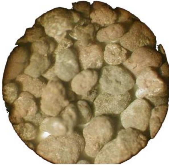
Рисунок 8.3 – Донная зола через 1,5 месяца с начала работы котла
