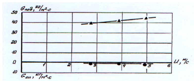
а) зонд у стенки, б) на 50 мм от стенки, в) на 100 мм от стенки Рисунок 2.6 – Влияние скорости отсоса на удельный расход материала для зондов, установленных на различном расстоянии от стенки
