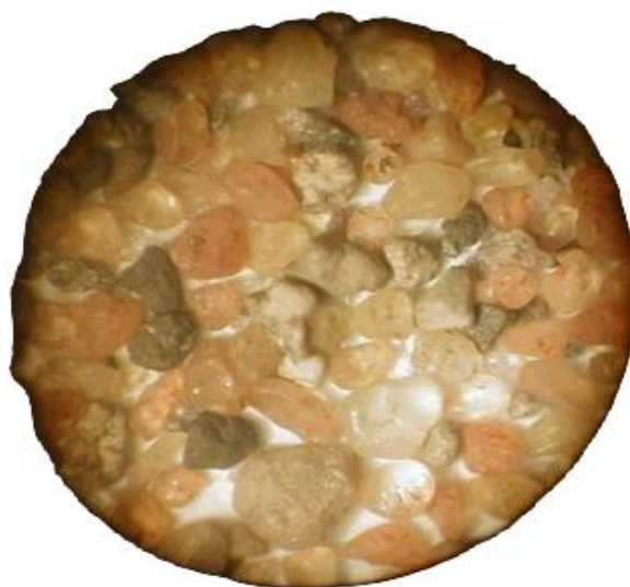
Рисунок 8.2 – Донная зола после недели работы котла
