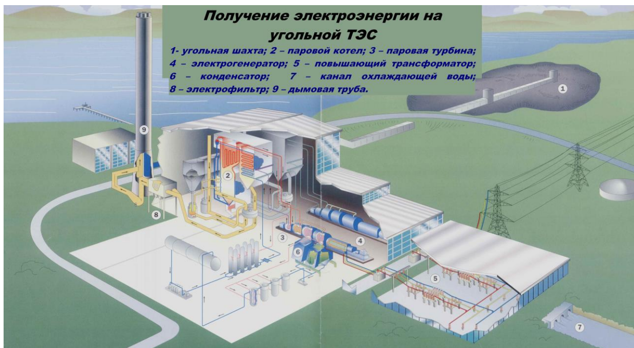
Рисунок 1 – Преобразование энергии на ТЭС
