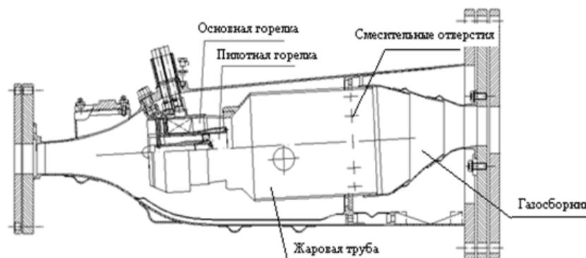
Рис. 26. Схема установки МЭКС ГТУ-6П в экспериментальном отсеке на стенде ВТИ
