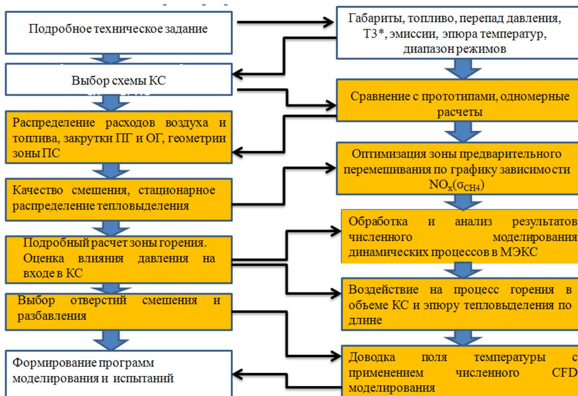
Рис. 29. Алгоритм использования математического моделирования при разработке и доводке КС
